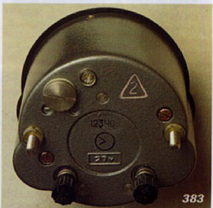
Die „123 4C“ (Bild 383) ist eine „60 4П“ mit Heizung.
