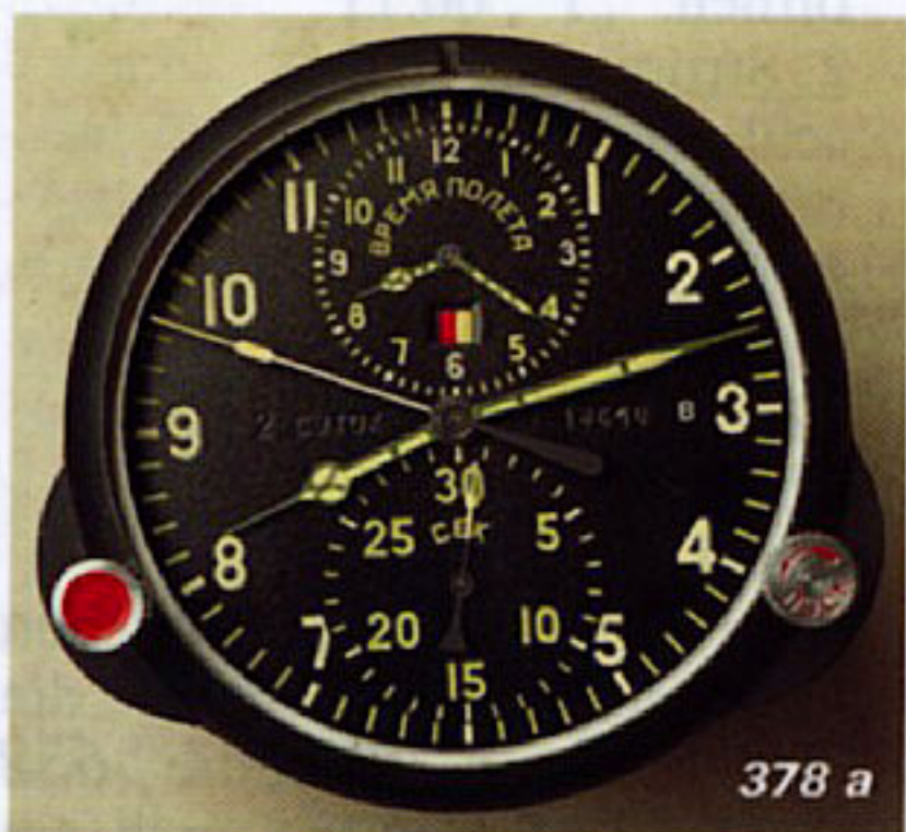
Die „A4C 1 M“ (Bild 378 b) hat ein modifiziertes Werk (Bild 379) und ein eigenes Zifferblatt (Bild 378 a).
