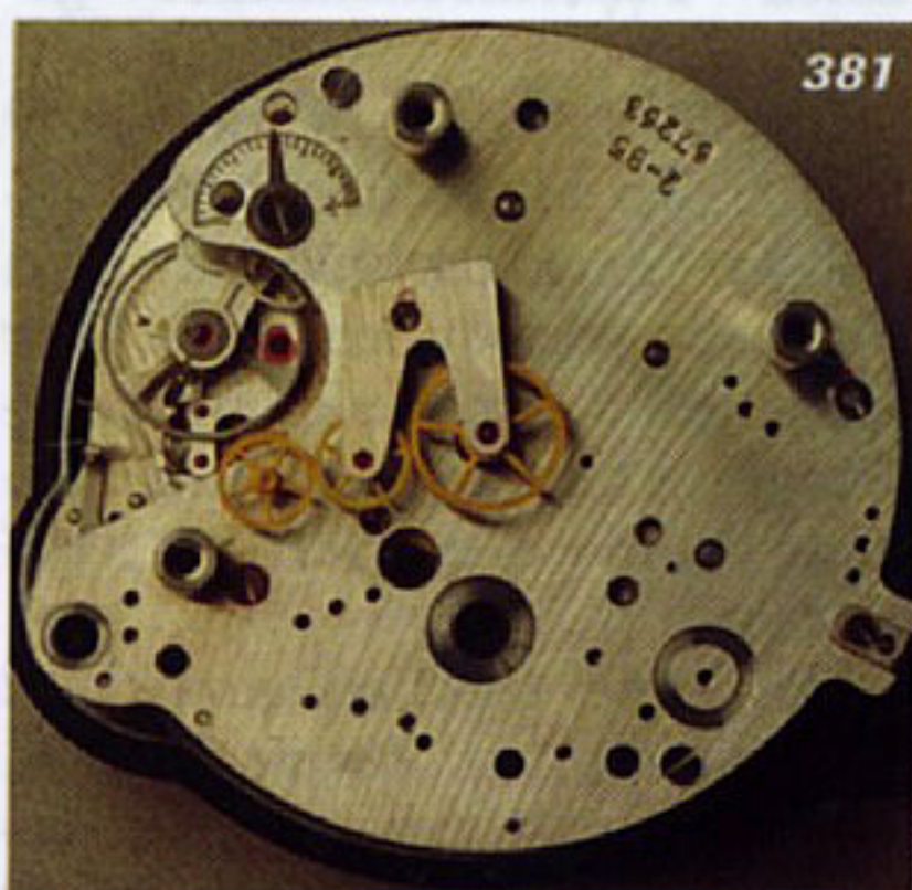
Die „122 4C“ (Bilder 380 a und b) ist die einfachste Ausführung der Borduhren. Die Platinen (Bild 381) sind für alle Komplikationen vorbereitet.
