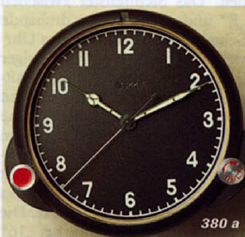
Die „122 4C“ (Bilder 380 a und b) ist die einfachste Ausführung der Borduhren. Die Platinen (Bild 381) sind für alle Komplikationen vorbereitet.
