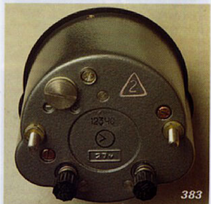
Die „123 4C“ (Bild 383) ist eine „60 4П“ mit Heizung.
